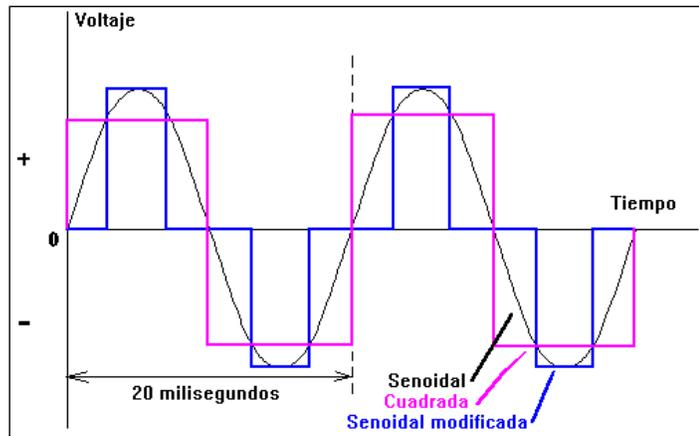
Diferentes formas de onda en corriente alterna (60Hz)
