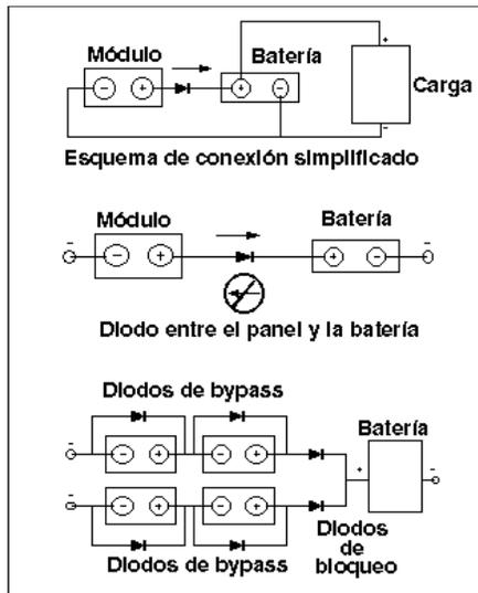
Esquemas de conexión con diodos
