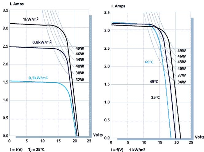
*Variación de intensidad y tensión con la radiación y la temperatura segun potencia nominal*
