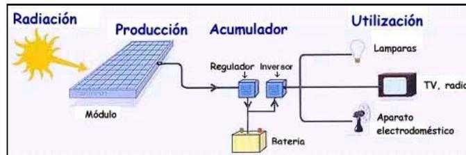
Una instalación solar fotovoltaica con inversor, utilización a 110Vca
