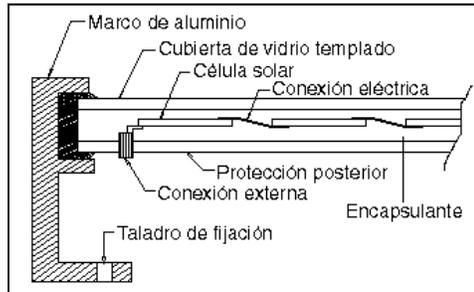
*Corte transversal de un panel fotovoltaico*
