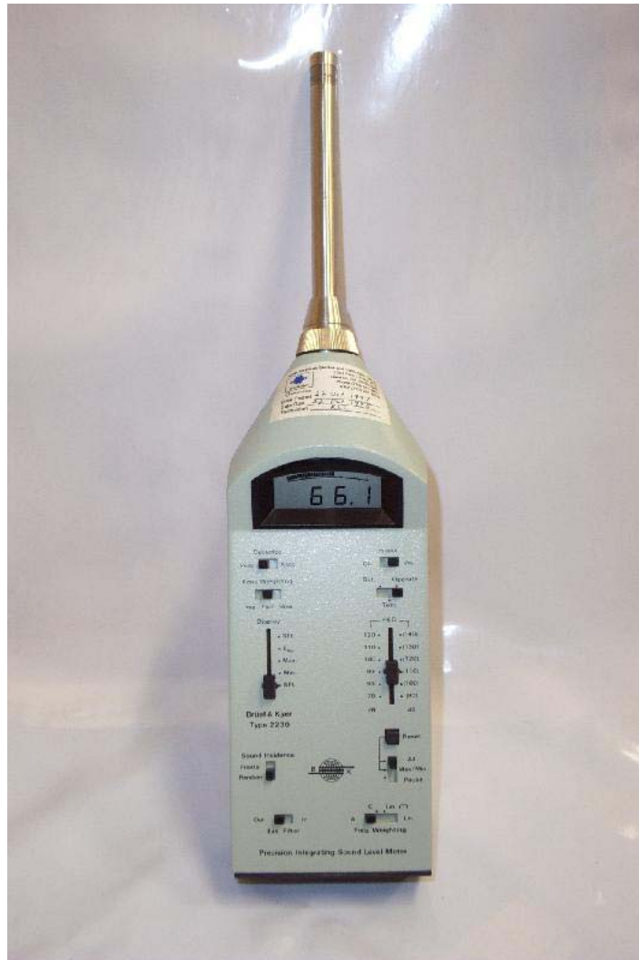
Fig. 4.6 Medidor de Nivel de Presión Sonora Bruel and Kjaer modelo 2232
